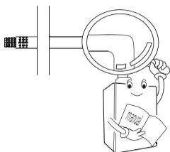
Instale la chimenea con el soporte de fijación de la chimenea que calza en los agujeros de conexión.
