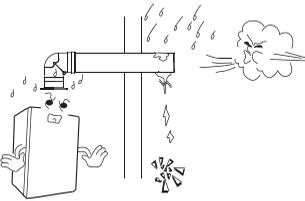
**Selle las partes del muro donde pase la chimenea para evitar que los gases de escape entren al hogar.**
