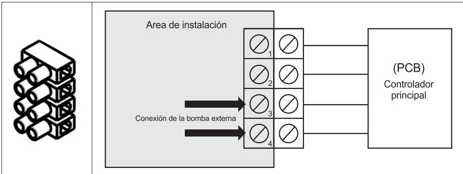
※ La bomba externa de la calefacción debe estar conectado a la tierra del chasis.
